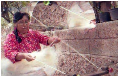
Con el apoyo de un motor y la técnica de "torcido" hilan grandes extensiones de la fibra, haciendo una sola cuerda.
